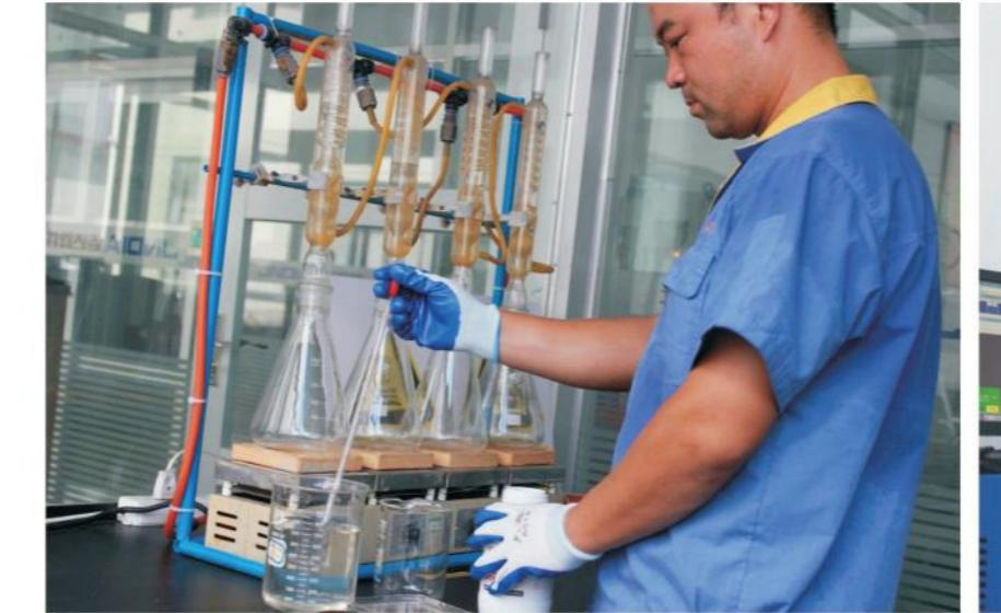
晶间腐蚀corrosion test
