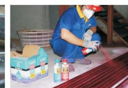
无损探伤Liquid penetrant Test
