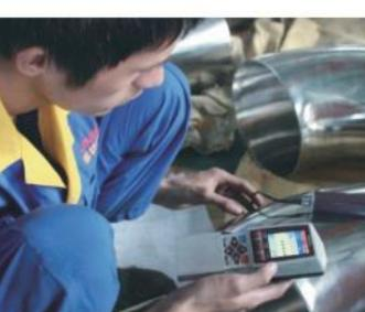
双相钢铁素体检测Ferrite Meter test
