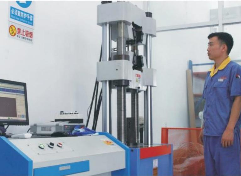
拉伸试验tensile test
