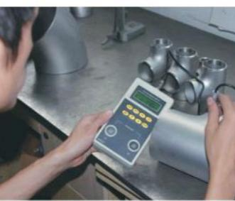
超声波测厚ultrasonic wt testing
