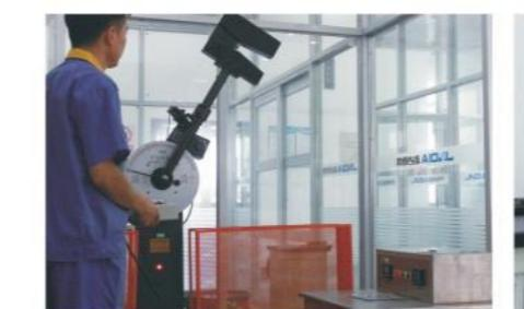
冲击试验charpy impact test
