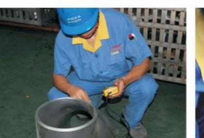
超声波测厚ultrasonic wt testing
